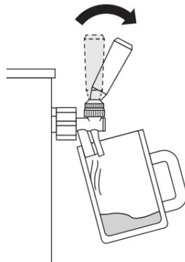
**3** 所定量のビールを注出したら、注出タップのレバーを元の位置に戻してビールの注出を止めます。
