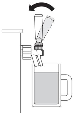
**4** 注出タップのレバーを後ろに押し泡付けしてください。
