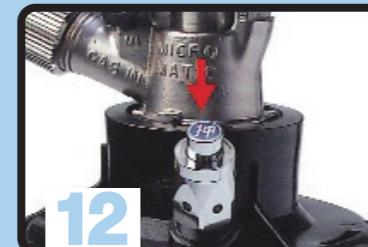
12 洗浄樽のガス抜きボタンを押して残りのガスを抜きます。
