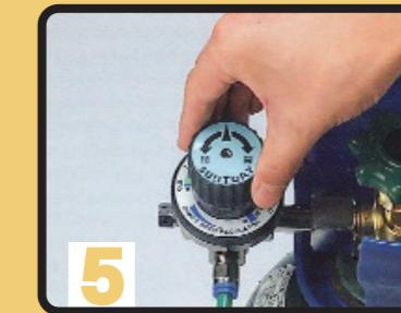
5 圧力は営業中にビールを出していた時と同じ圧力に調整します。
