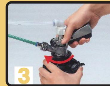
3 ヘッドを洗浄樽に取り付け、時計回りに止まるまで回します。
