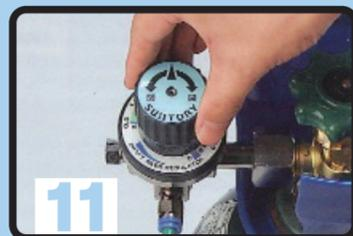
減圧弁の圧力設定ダイヤルを「0」へ戻し、元栓を締めます。
