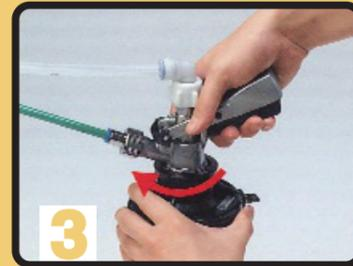
ヘッドを洗浄樽に取り付け、時計回りに止まるまで回します。
