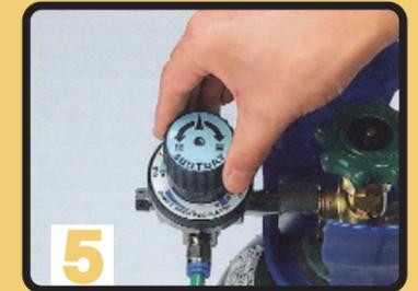
圧力は営業中にビールを注出していた時と同じ圧力に調整します。
