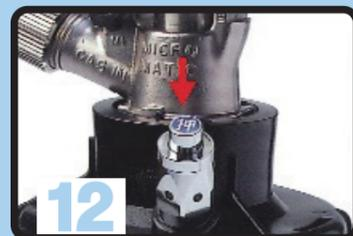
洗浄樽のガス抜きボタンを押して残りのガスを抜きます。
